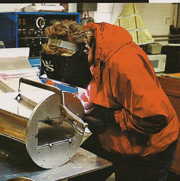
每隻中低音 Horn 喇叭都要以人手燒焊而成。
