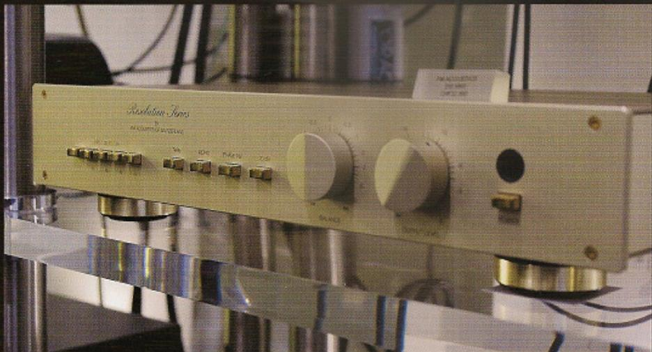
少信号在器材环节的污染或衰减，从而使动态压缩或声音劣变的可能性降到最低。FM115采用了完全平衡的三级推挽无电流反馈放大电路。也就是确保从输入到输出整个过程都是纯正的A类工作模式，同时还对于大多数竞争对手最薄弱的输出端进行了特别强化。
