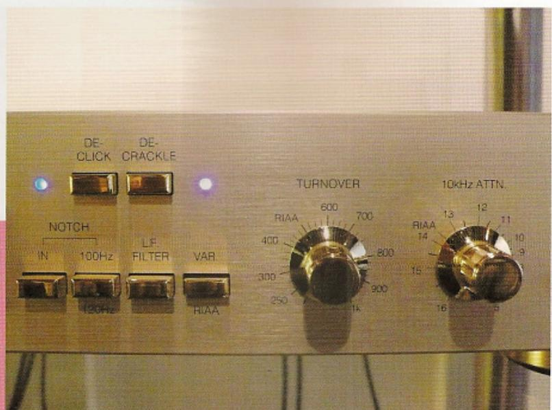
能够更好的应对不同类型的唱头，在面板中间位置设有一个暗藏式的调整窗口，实际操作起来的时候非常简单。在性能方面，除继承了其一代王牌机种的显著特点外，今天的这部唱头放大器特别加入了能够抑制噪声的功能。LP唱片的使用寿命非但是听一次则少一次，而且，随着波盘次数的增加，唱片的轨迹与唱针的日益摩擦，也会使得唱片陈旧，从而使得在播放时的噪音声便大。在这种时候，FM Acoustics 223唱头放大器上新配备的“De-Click”、“De-Crackle”按钮就能够起到显著的作用。一个与众不同的特点是，这种能够分别针对老唱片噪音与唱片表面磨损划伤而产生的噪音进行滤除和降低的处理功能，其不会对重放音效产生
