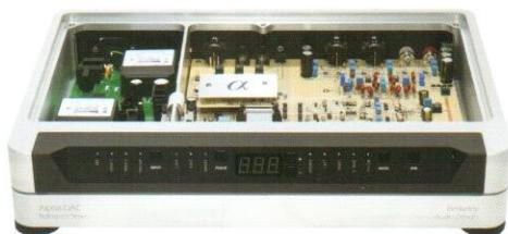
震條件，結構異常紮實，擁有一體化的側板、底板、內部間隔及部份面板與背板，獨立的頂板亦為厚約10mm的鋁合金製作。跟機箱結構一體化的內部間隔，更將供電部份與音頻電路高度隔離，謝絕雜訊入侵音頻電路。
