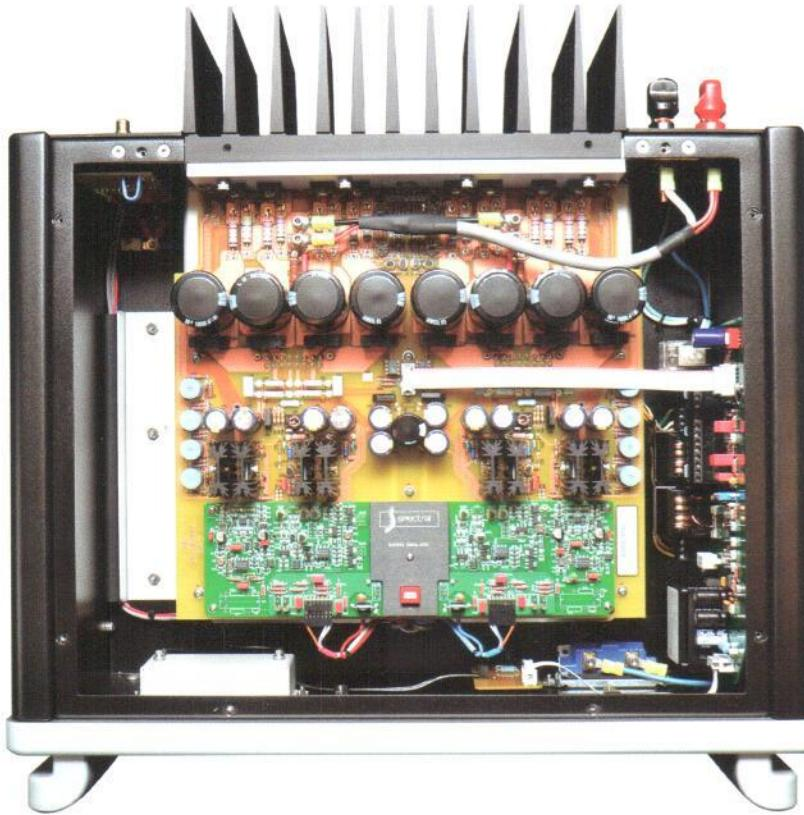
結合兩者之優勢。在最新又先進的增益級上之元件，更引入用於發展高清顯像的半導體技術，再加以度身訂造，配合全新的雙推挽兼全平衡增益架構，令速度倍增，阻抗更低更穩定，驅動輸出級的匹配性亦有明顯改進。再以高靈敏度的JEFT，配合驅動力強又緊湊的MOSFET輸出級，用於最新的獨家技術“Focused Array”高速/高電流輸出級之上。
