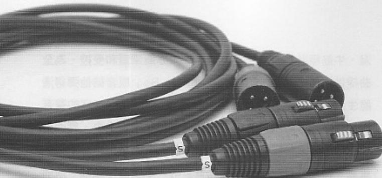
FM Acoustics訊號線多年來都只有一款，就是PIT，身形並不粗大，在高級音響接線領域中甚至可算是纖幼，外表還相當平實，外皮印上了「Precision Interface Technology Switzerland」。PIT採用4芯（多芯式multi-strands）1綱純銅設計，沒有用銀，包裹着導體的絕緣體是Teflon。PIT沒有散線賣，全部在廠接上插頭，除了是純平衡和純單端式接駁外，還有單端平衡混合式接駁，甚至是5 pin唱臂線亦有提供。
