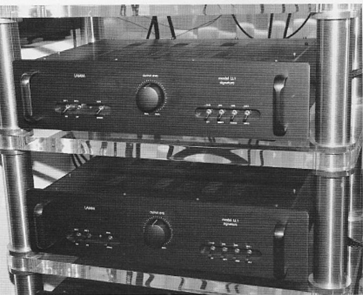
每聲道放大電路使用4支俄羅斯製，具低噪音、高可靠性能與及極耐用的Sovtek 6N30P-DR（其原型為6H30）雙三極真空管，以並聯式組造成一組倒相輸出的增益級（Conrad Johnson膽前級亦是倒相輸出）；用家採用同廠或別廠出品的正相輸入晶體管或真空管製作的功率放大器與它搭配，而音源或功率放大器沒有附設正相與倒相功能切換掣時，想取得絕對正確的相位，最簡單直接的方法是把喇叭線的其中一端「正接負」；「負接正」即可。
