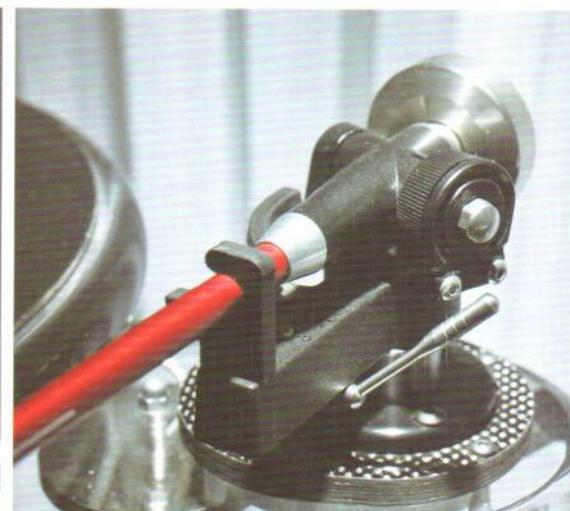
和内阻尼特性都极佳的碳纤维编织复合材料制造，想必是厂方反复试验下的结果。碳纤维是含碳量高于90%的无机高分子纤维，而其中含碳量高于99%的称石墨纤维。碳纤维的轴向强度和模量高，无蠕变耐疲劳性好，比热及导电性介于非金属和金属之间，热膨胀系数小，耐腐蚀性好。碳纤维更是一种力学性能优异的材料，它的比重不到钢的1/4，碳纤维树脂复合材料抗拉强度一般都在3500Mpa以上，是钢的7~9倍，抗拉弹性模量为230~430Gpa，亦高于钢。因此材料的强度与其密度之比可达到2000Mpa/(g/cm<sup>3</sup>)以上，而A3钢的比强度仅为59Mpa/(g/cm<sup>3</sup>)左右。材料的比强度愈高，则构件自重愈小，比模量愈高，则构件的刚度愈大。从这个意义
