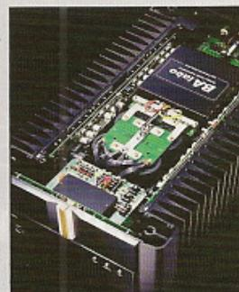
BP-1 MK II 后级也提供一组常见于专业用途的旋入式输出插座，提供给更可靠的连接性能。采用专业用的 PowerCon 连接器，PowerCon 的接触电阻只有常规 IEC 插座的三分之一，而且能够通过最大 20A 额定电流，还采用了选入式设计，提供卓越的可靠性和产品安全性。喇叭线接线柱选择手柄非常粗壮，而且间距宽阔，相信无论连接蟒蛇级的喇叭线也没有难度
