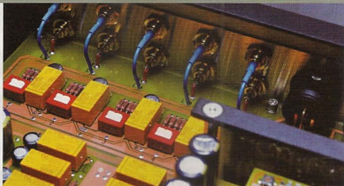
线路关键之处的 SHHA 放大模块是自 2003 年从 DMC-30 开使用的，之后所有 Spectral 前级也都采用更新型的 SHHA 放大模块，通过几代机型的改良，现在速度响应、稳定性、散热能力、耐温特性都以入化境。线路关键点以手工挑选的可变电阻取代以前的偏压调整电阻，金属皮膜电阻以手工挑选，聚丙烯电容是特别订制的，超前的设计加上严选元件使 Spectral 前级的频宽达 MHz 的级别，而且可以输出高达 1 安培的电流，极为罕见。
