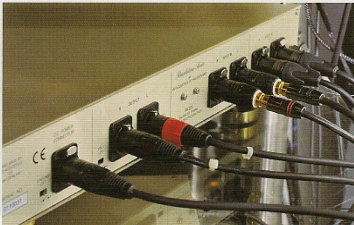
采用全平衡及分体电源设计，分体电源输入口
