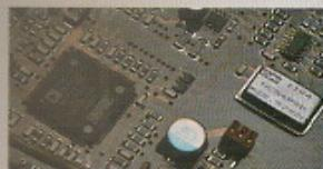
讯号传输线路采用平衡架构，可以完全抵消数码杂讯。从线路结构上看，SDR-4000SL 的 Spectra lock 主时钟线路并非一般数码讯源中的独立线路，而是从转盘的伺服线路开始整合，紧密结合了 DAC 线路、超精密晶振和独立电源供应的超低讯噪线路。
