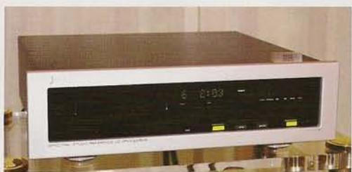
1987年, Spectral曾推出动圈式(MC)唱头,同时也推出他家第一部数字产品SDR-1000 CD系统,这是Keith O. Johnson针对市面上CD唱机缺点与数字录音缺失而设计出来的CD播放系统。SDR-1000的各项设计即使在今天依然毫不落伍,它是第一部完全美国设计生产的Hi End CD唱机 第一次采用时基误差控制,还提供三种滤波选择用于改善编码时相位失真的CD机 它同时也是第一部采用测试仪器要求的CD唱机,拥有超宽频宽、推挽平衡输出,纯A类线路以及模块插槽设计。试听时我们搭配更新的SRD-4000S CD机,当然有HDCD解码,24 Bit芯片双平衡线路,失真低至0.001%以下,与今天最贵的CD唱机相比都是很先进的设计。
