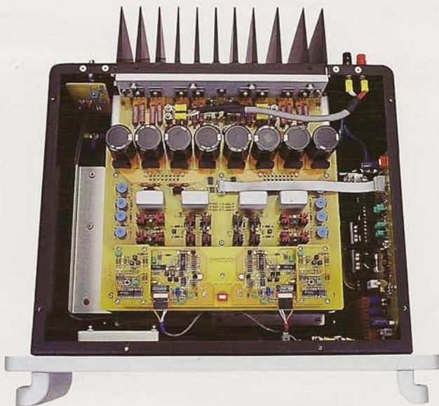
采用垂直空间设计的后级，线路板上、下垂直摆放，一方面让讯号路径到最短，另一方面则降低电磁场干扰。这也是第一部采用所谓Focused Power设计的后级，也就是每一个功率晶体都有自己独立的整流滤波线路，甚至有自己的变压器供电，假如有四个功率晶体那么电源变压器内就有四组独立绕组分别对功率晶体供电，而专用的整流滤波组件就紧靠功率晶体摆放，以求最短供电路径，目的是希望得到最快速、最干净、最大的电源供应。DMA-180还是第一部采用非介入式温度伺服DC输出飘移控制线路的后级，在讯号路径上没有加入任何保护线路，使得输出的音乐讯号得以保持纯净。DMA-180的独特设计一直沿用至今，在它之后开发出了立体声的DMA-100S、DMA160S、DMA-250及本文的主角DMA-360单声道后级。至于前级部分则有DMC-15、DMC-30、DMC-30SL与最新的DMC-30SS。
