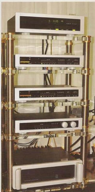
Spectral的产品并不多，下面二部器材分别是DMC-15前级与DMA-250立体声功放（输出功率200瓦/8欧姆，570瓦/2欧姆）。
