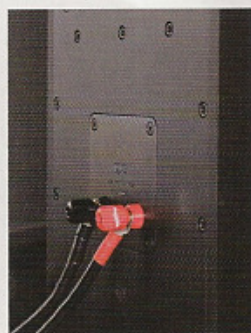
背板采用数十颗螺丝紧固，接线柱为单线输入。
