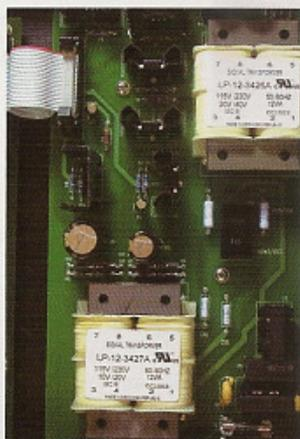
采用两只变压器分别为数码及模拟电路供电。
