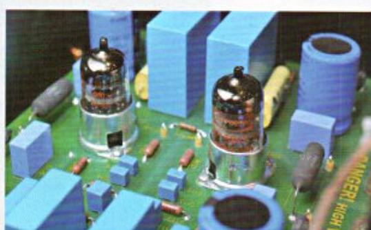
电子管信号放大采用美国西电 417A 和 5842 电子管
