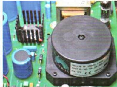
重磅的电源供应设计，采用Plitron环形变压器供电
