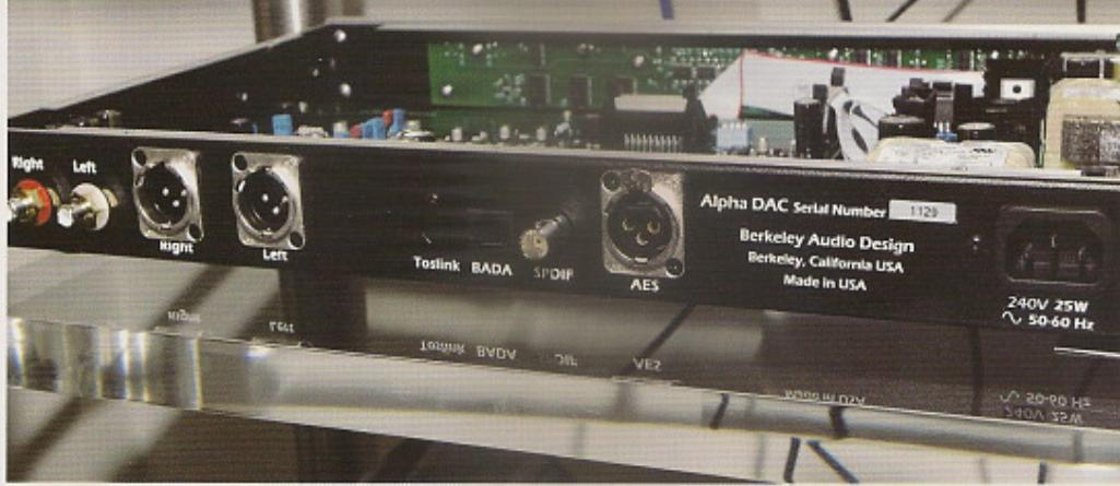
背部接线端子，光纤、RJ-45、同轴、平衡通通齐备
