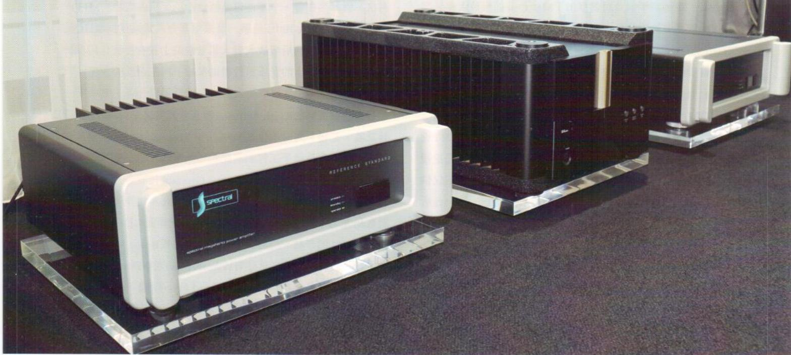
Spectral的声音表现而购买且感到非常的自豪。而本次要试听的Spectral DMA-400 Monaural Reference Standard名字非常长，但定位亦是非常鲜明，是继DMA-360后的又一新旗舰参考级标准的单端后级放大器，输出功率方面在8欧姆负载下有着350瓦输出功率，在4欧姆负载下可达到560瓦功率，若在2欧姆负载下更能大达到705瓦的输出功率，但需要非常强调的是，Spectral对输出数字的标准非常准确，性能达标率非常严谨，多1瓦和少1瓦都是不被允许，这在之前的DMA-100S就是最好的说明，输出功率标示为159瓦，绝对就是159瓦，多1瓦凑齐整数都不肯。另外，在器材尺寸上同样道理，DMA-400为50.8厘米×18.4厘米×49.9厘米，重量为34kg（台），这些数字都极为准确，连0.1个数量单位都要计较。造型高档并有瑞士风格，面板厚度就达2公分，由铝合金面板制作而成外框，这面板判断肯定是一体成型，需要用到大型切削工具才能完成，每一个角位圆滑精细而不刮手，正面面板为黑色的亚克力制作，上面只有一个大型的开关按键，左右两旁
