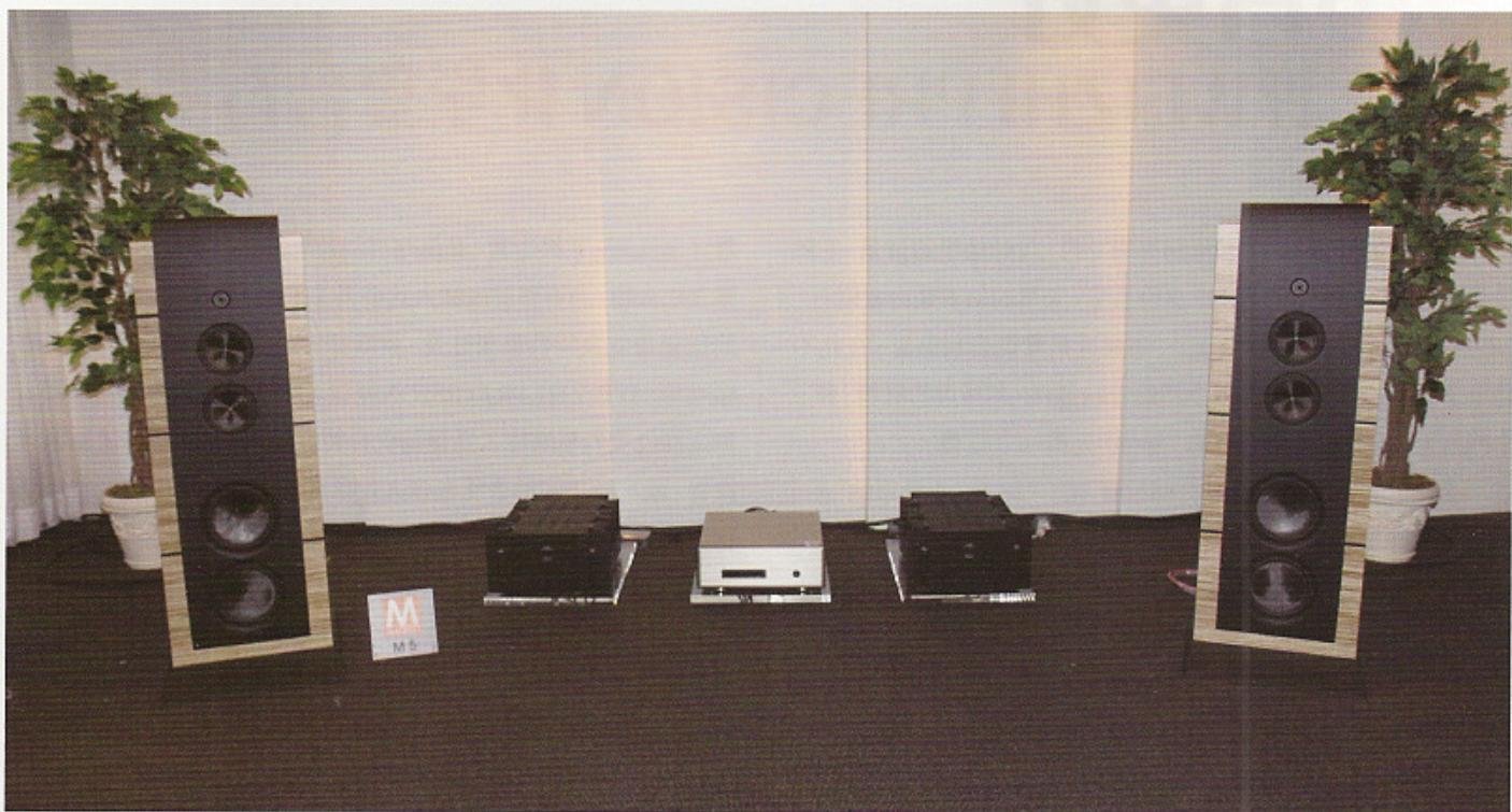
低的失真。而且高音单元被安装于特别设计的一体式铝合金前面板上，前面板的喇叭开口位是经过电脑特别设计的精密扩散弧度，如此独特的设计可以进一步降低绕射的干扰。此外，音箱还搭载了两只中音和两只低音单元，它们都采用了新开发的Nano-Tec碳纤维编织振膜单元，它更是全球第一个采用“ESXO”（Elliptical Symmetry Crossover）结构的扬声器，实现了音盘的整体的力学分布，可以带来更理想、更出色的声音准确性。在FM 411MK II合并后级扩大机的推动下，M5呈现出来的音质之好是出乎我的所料的，声音如此绵密、高密度，的确是Hi-end中的发烧铭器。
