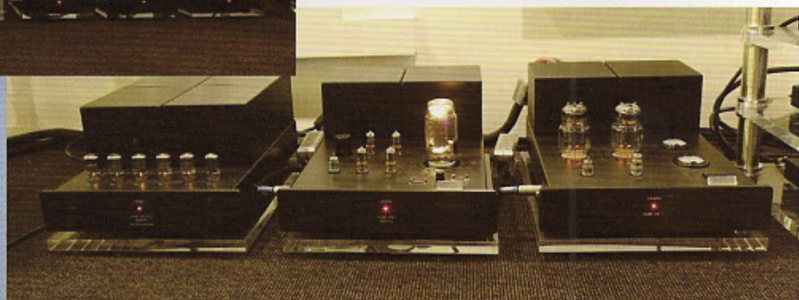
▲这三台电子管放大器是用来推动除超高音号角单元和15"直径锥盘超低音单元的
